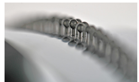
„Endloser“ Teilverbund: Zwischenformen werden vollautomatisiert an ein Trägerblech geschweißt. Quelle: Ulrich Reiß.
