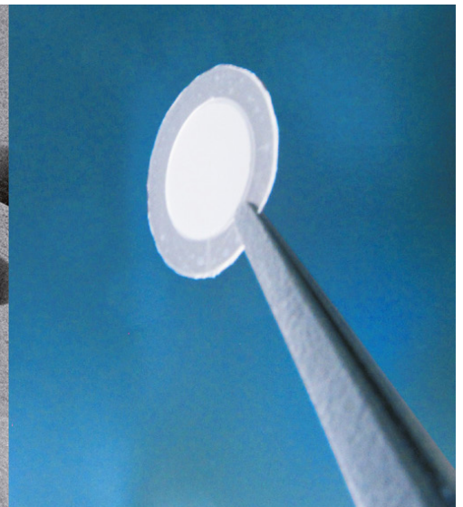
Konisch strukturierte Membran zur selektiven Filterung spezifischer Zelltypen. Quelle: temicon GmbH
